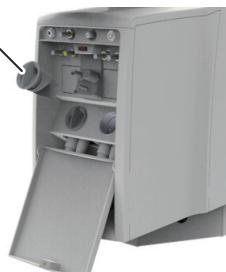
\* Entfernen Sie nicht den Feststoffsammler während des Waschvorgangs. Ohne den Feststoffsammler funktioniert die Absaugung nicht.
