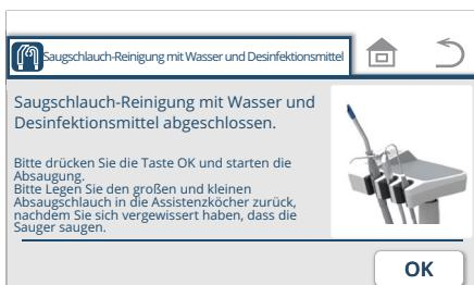
3. Wenn Sie das Spülen der Absaugleitung + Auswaschen der Absaugleitung mit Reinigungsmittel beendet haben, drücken Sie den **OK**-Schalter.
