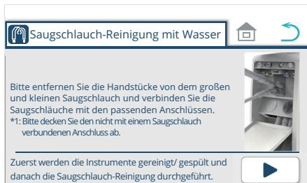
6. Öffnen Sie die Frontplatte der Mundspülbecken-Einheit. Nehmen Sie das Absaug- und Speichelsauger-Handstück aus dem Helferinnen-Halter und setzen Sie sie in den Anschluss ein.
