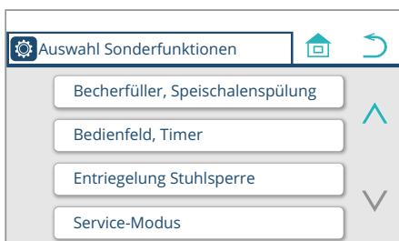
3. Drücken Sie 'Entriegelung Stuhlsperre'. Der Einstellungsbildschirm für Notentsperrung der Stuhlverriegelung wird angezeigt.
