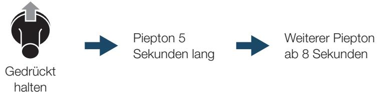
Lassen Sie den Joystick-Schalter für den automatischen Betrieb nicht los, während der Piepton ertönt. Wenn Sie den Joystick-Schalter loslassen, wird die Bewegungsposition als Mundspülposition gespeichert.
