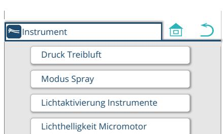
3. Drücken Sie auf 'Modus Spray'. Der Einstellbildschirm für den Sprühmodus wird angezeigt.
