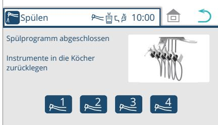
Wenn das Entleeren abgeschlossen ist, startet das Spülen der Absaugleitung.
