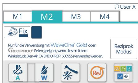
Im Reziprokmodus oszilliert der Mikromotor im voreingestellten Winkel, mit der voreingestellten Beschleunigung und dem voreingestellten Drehmomentwert. Dieser Modus ermöglicht nur den Start oder Stopp des Betriebs.
