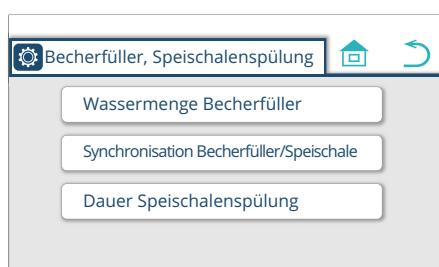
4. Drücken Sie ,Synchronisation Becherfüller/Speischale'. Der Bildschirm für die Kopplung von Becherfüllung und Beckenspülung erscheint.
