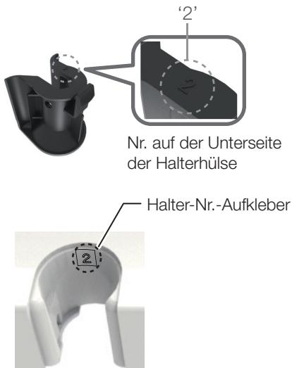
Bei jeder Halterhülse steht die Nummer an der Unterseite und ein Aufkleber mit derselben Nummer befindet sich am Helferinnen-Halter.
