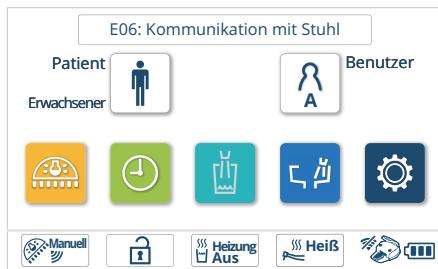
Beim Ausschalten des Stuhls wird „E06: Verbindung mit dem Stuhl“ auf dem Touchpanel angezeigt, da die Verbindung zwischen der Einheit und dem Stuhl unterbrochen ist, anschließend leuchtet die LED-Anzeige der Mundspül-Einheit orange auf, was keine Fehlfunktion ist.
