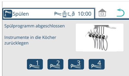
7. Wenn das Spülen der Absaugleitung abgeschlossen ist, setzen Sie die Handstücke für die Arzteinheit wieder in den Instrumentenhalter ein.
