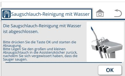
3. Wenn das Spülen der Absaugleitung abgeschlossen ist, drücken Sie den **OK**-Schalter.
