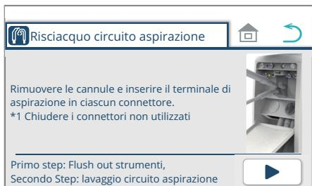
6. Aprire il pannello anteriore dell'unità sputacchiera. Prendere i manipoli di aspirazione e aspirasaliva dal supporto assistente e inserirli nel connettore.
