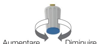
Tutte le manopole diminuiscono la portata quando vengono ruotate in senso orario e la aumentano quando vengono ruotate in senso antiorario.
