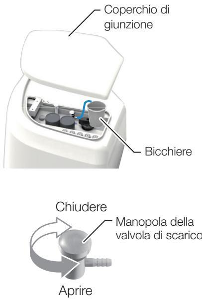
Svuotare l'acqua eventualmente accumulata nel filtro dell'aria almeno una volta alla settimana.
