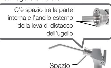
C'è spazio tra la parte interna e l'anello esterno della leva di distacco dell'ugello
