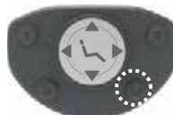
Déplacez le fauteuil en position de rinçage avec l'interrupteur manuel du fauteuil
