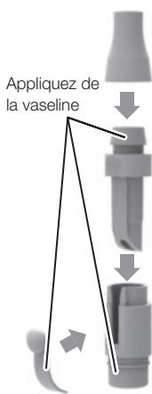
Après la stérilisation par autoclave, démontez les pièces à main, appliquez de la vaseline et ré-assemblez avant utilisation.
