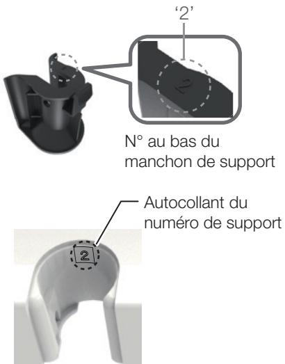
Chaque manchon de support porte un numéro en bas et un autocollant indiquant le même numéro est apposé sur le support d'assistant.
