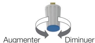
Tous les boutons diminuent le débit lorsqu'ils sont tournés dans le sens des aiguilles d'une montre et l'augmentent lorsqu'ils sont tournés dans le sens inverse des aiguilles d'une montre.
