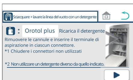
2. Avviare il risciacquo della linea di aspirazione + il lavaggio della linea di aspirazione con detergente.
