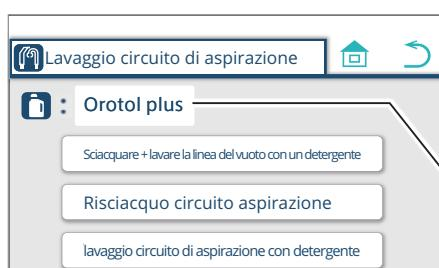
\* Se si seleziona 'Lavaggio circuito di aspirazione', verrà controllata la quantità di detergente rimanente. Se la quantità di detergente è sufficiente, viene visualizzata la schermata mostrata nella figura a sinistra.
