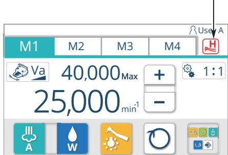
Se il prodotto viene utilizzato per un lungo periodo con un carico elevato, la funzione di prevenzione surriscaldamento viene attivata e la coppia viene automaticamente diminuita per evitare il surriscaldamento dell'unità micromotore. In questo caso, viene emesso un segnale acustico e viene visualizzato **H**. Mentre viene visualizzata questa indicazione, la funzione di prevenzione surriscaldamento è attivata.
