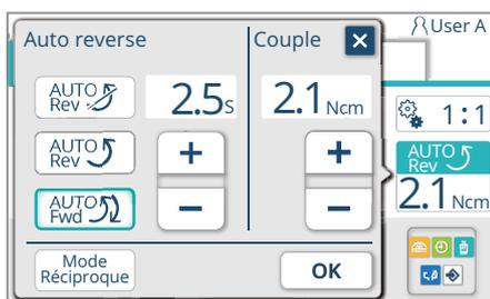
4. Sélectionnez la fonction avant automatique
