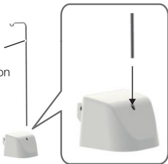
2. Insérer le support d'irrigation dans le trou situé à l'arrière du couvercle de la pompe.
