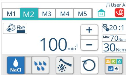
Lorsque la pièce à main est en fonctionnement, la vitesse de rotation réelle est affichée. Lorsqu'elle n'est pas en fonctionnement, la vitesse de rotation maximale réglée est affichée.
