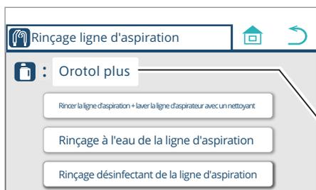
1. Appuyez sur l'interrupteur « Rincer la conduite d'aspiration + laver la conduite d'aspiration avec un nettoyant ».
