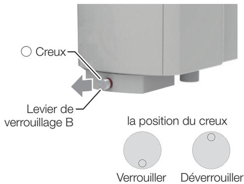
12. Tournez le levier de verrouillage B de sorte que le creux soit en position abaissée. Il est possible que le levier de verrouillage B ne revienne pas en position de verrouillage. Dans ce cas, réglez la position du corps du crachoir jusqu'à ce que le levier de verrouillage B revienne en position de verrouillage.
