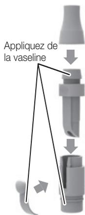
Après la stérilisation par autoclave, démontez les pièces à main, appliquez de la vaseline et ré-assemblez avant utilisation.
