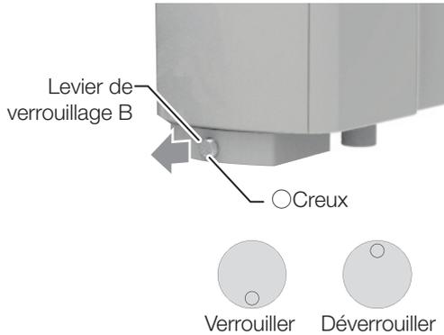
5. Tirez le levier de verrouillage B en bas du crachoir jusqu'à ce que le repère rouge soit visible, puis tournez le levier de verrouillage B de sorte que le creux soit en position haute.
