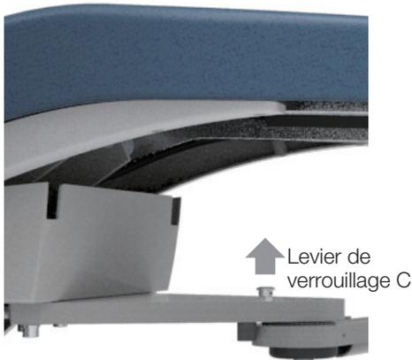
Le levier de verrouillage C peut être difficile à tirer. Dans ce cas, tirez le levier de verrouillage C vers le haut tout en ajustant la position de la colonne lumineuse.
