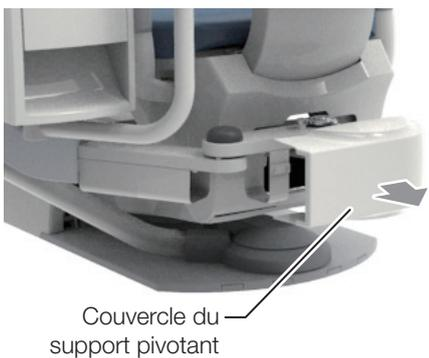
7. Retirez le cache du support pivotant en tirant dans le sens de la flèche. Tirez le levier de verrouillage A vers le haut et tournez-le jusqu'à ce que le levier soit verrouillé en place.
