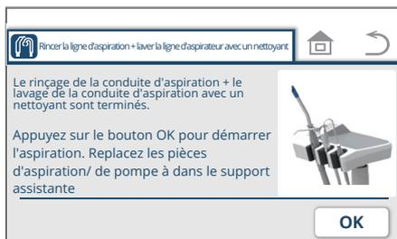
3. Lorsque vous avez terminé le rinçage de la conduite d'aspiration + lavage de la conduite d'aspiration avec un nettoyant, appuyez sur l'interrupteur
