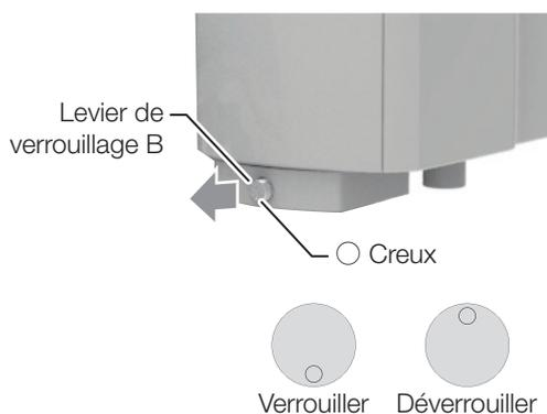
Le levier de verrouillage B peut être difficile à tirer. Dans ce cas, tirez le levier de verrouillage B vers le haut tout en ajustant la position du crachoir.
