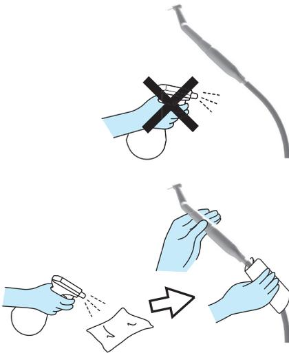
Ne pulvérisez pas le détergent directement sur l'extérieur de l'appareil. Nettoyez la surface avec un chiffon doux ou une serviette en papier humidifié avec un détergent, et essuyez-la avec un chiffon sec. Si du liquide pénètre dans le produit, cela risque de provoquer un dysfonctionnement ou une panne.
