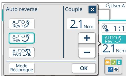
4. Sélectionnez le réglage requis de la fonction arrière automatique/fonction avant automatique
