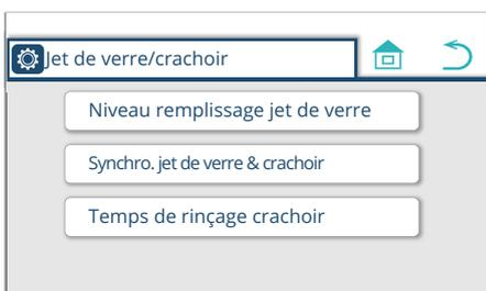
4. Appuyez sur « Niveau d'eau remplissage jet de verre ». L'écran de réglage du niveau d'eau de remplissage du gobelet apparaît.
