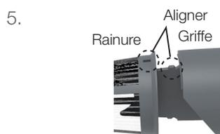
5. Alignez la griffe sur le capuchon du collecteur de solides avec la rainure du filtre pour les fixer.
