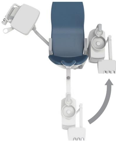
10. Faites pivoter le crachoir et le support auxiliaire comme indiqué sur la figure de gauche. Lorsque le crachoir atteint la position correcte, comme indiqué sur la figure de gauche, le levier de verrouillage A sur le support pivotant se verrouille automatiquement.
