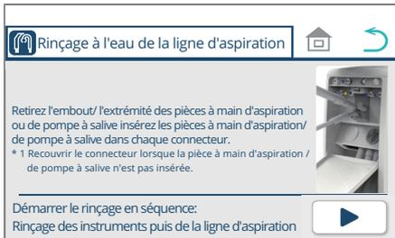
\* Pour arrêter le lavage de la ligne d'aspiration en cours, appuyez sur l'interrupteur .
