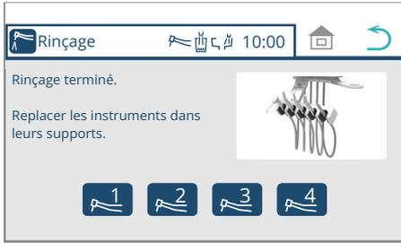
7. Une fois le rinçage de la conduite d'aspiration terminé, remplacez les pièces à main de l'unité médicale sur le support de l'instrument.
