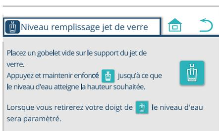
5. Placez un gobelet vide sur la base de remplissage, et appuyez sur l'interrupteur
