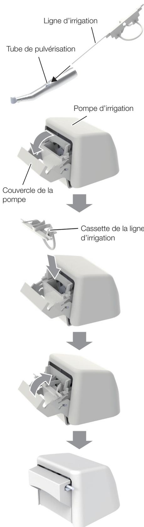
5. Connecter la ligne d'irrigation au tube de pulvérisation d'une pièce à main (droite ou contre-angle).
