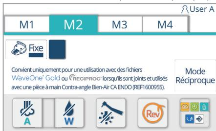
Un signal sonore retentit et l'écran du micromoteur (mode réciproque) s'affiche. Le réglage du mode réciproque est mémorisé dans les conditions de démarrage après la mise sous tension.
