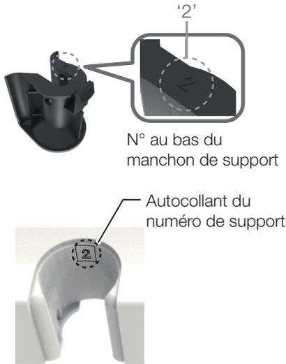
Chaque manchon de support porte un numéro en bas et un autocollant indiquant le même numéro est apposé sur le support auxiliaire. Veuillez à fixer le manchon du support sur le support ayant le même numéro.
