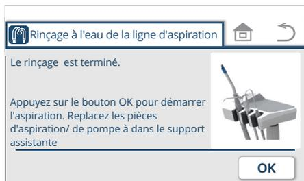
3. Une fois le rinçage de la conduite d'aspiration terminé, appuyez sur l'interrupteur **OK** .
