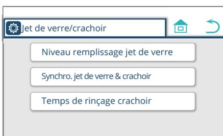
4. Appuyez sur « Temps de rinçage cracoïr ». L'écran de réglage du temps de rinçage du cracoïr apparaît.
