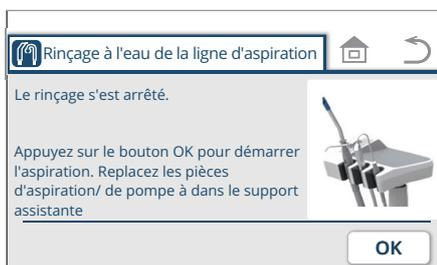
\* Une fois que l'aspiration commence, remettez les pièces à main d'aspiration et de pompe à salive sur le support auxiliaire. Lorsque les pièces à main d'aspiration et de pompe à salive sont replacées sur le support de l'assistant, l'écran revient à l'écran d'accueil.
