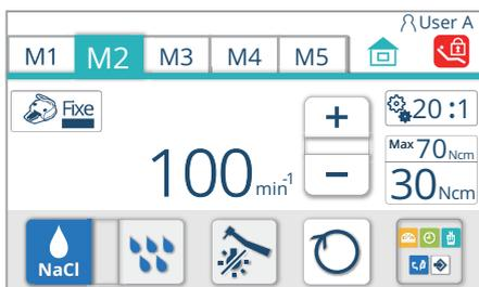
Chaque pression sur l'interrupteur au pied modifie la mémoire sélectionnée de la manière suivante : M1 → M2 → M3 → M4 → M5 → M1.
