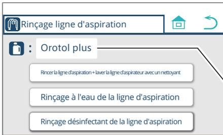
1. Appuyez sur l'interrupteur « Lavage de la conduite d'aspiration avec un produit nettoyant ».
