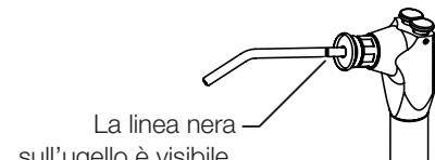
C'è spazio tra la parte interna e l'anello esterno della leva di distacco dell'ugello
