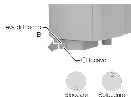
7. Tirare in avanti la leva di blocco B nella parte inferiore dell'unità sputacchiera fino a vedere la marcatura rossa, quindi ruotare la leva di blocco B in modo che l'incavo arrivi in posizione capovolta.
