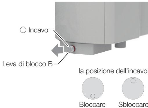
12. Ruotare la leva di blocco B in modo che l'incavo arrivi in posizione abbassata. La leva di blocco B potrebbe non tornare alla posizione di blocco. In tal caso, regolare la posizione del corpo della sputacchiera finché la leva di blocco B non si trova nuovamente in posizione di blocco.
