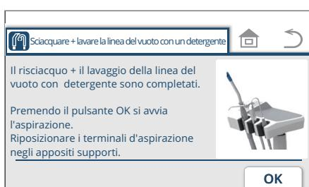
3. Al termine del risciacquo della linea di aspirazione + lavaggio della linea di aspirazione con detergente, premere l'interruttore .
