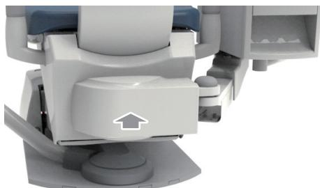
13. Fissare il coperchio della staffa oscillante sulla staffa oscillante.
