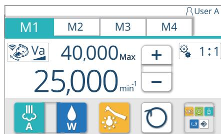
Quando il micromotore viene preso dal portastrumenti, viene visualizzata la schermata del micromotore.
