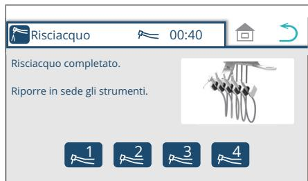
7. Una volta terminato il risciacquo, riportare il manipolo nel portastrumenti.
