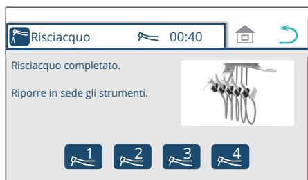
7. Una volta terminato il risciacquo, riportare il manipolo nel portastrumenti. Quando il manipolo viene riportato indietro, viene visualizzata la schermata iniziale.
