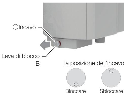
11. Ruotare la leva di blocco B in modo che l'incavo arrivi in posizione abbassata. La leva di blocco B potrebbe non tornare alla posizione di blocco. In tal caso, regolare la posizione del corpo della sputacchiera finché la leva di blocco B non si trova nuovamente in posizione di blocco.
