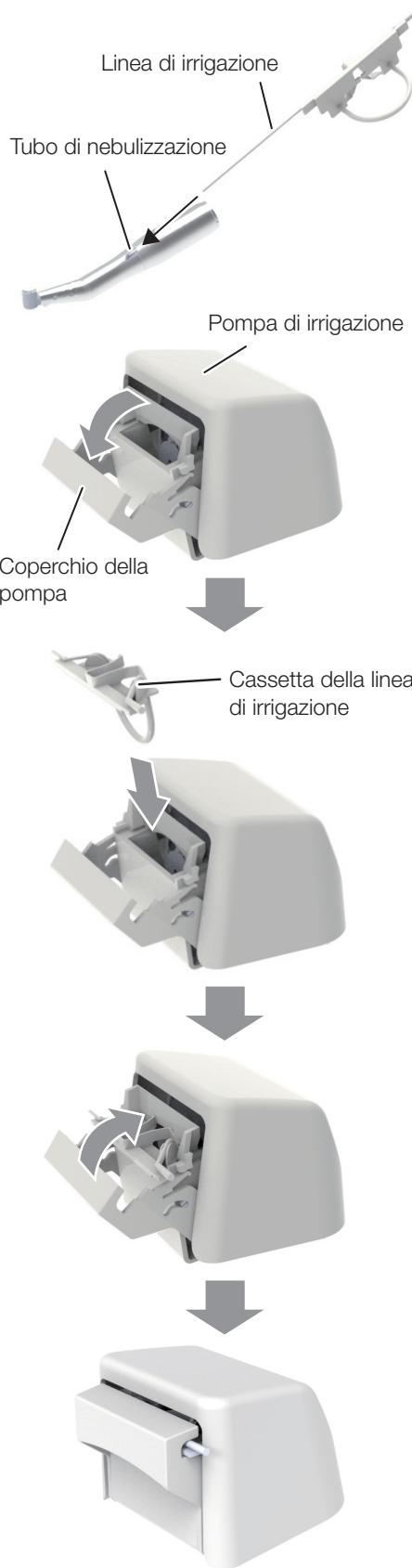
5. Collegare la linea di irrigazione al tubo di nebulizzazione di un manipolo (diritto o contrangolo).
