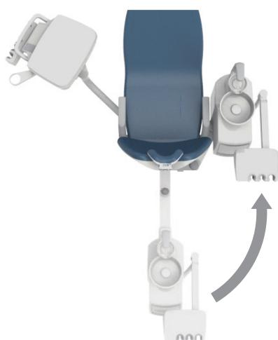
10. Fare oscillare l'unità sputacchiera e il supporto assistente come mostrato nella figura a sinistra. Quando l'unità sputacchiera raggiunge la posizione corretta, come mostrato nella figura a sinistra, la leva di blocco A sulla staffa oscillante si blocca automaticamente.
