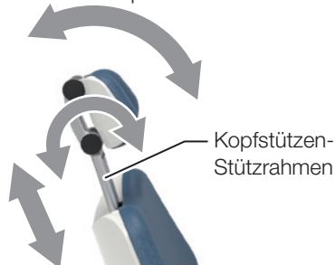
Winkel und Verstellung nach oben/nach unten der Kopfstütze
