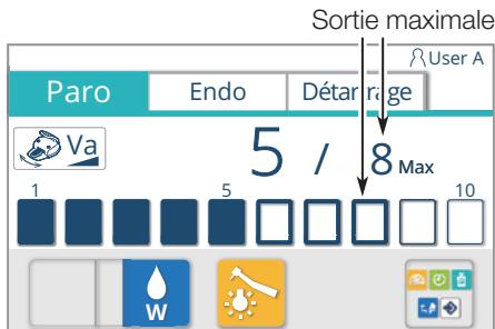
Réglage de la puissance maximale en mode de coulissemement Va
