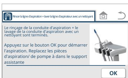
3. Lorsque vous avez terminé le rinçage de la conduite d'aspiration + le lavage de la conduite d'aspiration avec un nettoyant, appuyez sur l'interrupteur .
