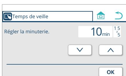
5. Appuyez sur les interrupteurs ▾ et ▾ pour sélectionner l'une des trois durées (' 5 min ', ' 10 min ' et ' 15 min ').
