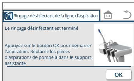
3. Lorsque vous avez terminé le lavage de la conduite d'aspiration avec un produit nettoyant, appuyez sur l'interrupteur .
