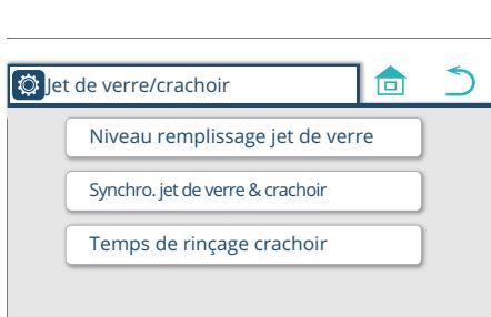
4. Appuyez sur ‘ Synchro jet de verre et crachoir ’. L'écran Synchronisation jet de verre et crachoir apparaît.
