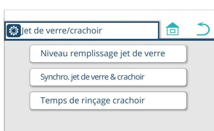
4. Appuyez sur ' Temps de rinçage crachoir '. L'écran de réglage du temps de rinçage du crachoir apparaît.
