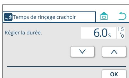
5. Appuyez sur les interrupteurs pour régler la durée entre [0] et [15] secondes.
