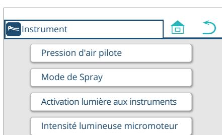
3. Appuyez sur 'Intensité lumineuse micromoteur'. L'écran de réglage de la luminosité de l'éclairage du micromoteur apparaît.
