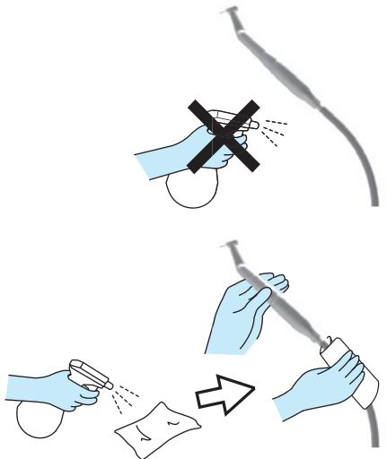
Ne pulvérisez pas de détergent directement sur l'extérieur de l'appareil.
