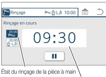
Si la vasque du crachoir n'est pas présente, le rinçage de la conduite d'aspiration démarre 5 minutes après le rinçage des circuits d'eau des pièces à main.
