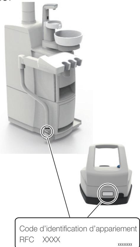
Si plusieurs exemplaires du produit sont utilisés au même étage, veillez à ne pas utiliser une pédale de commande sans fil couplée à une autre unité.
