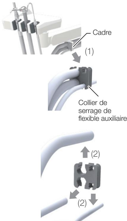
Le collier de serrage de flexible auxiliaire peut se détacher du cadre, ce qui est pratique pour le nettoyage.
