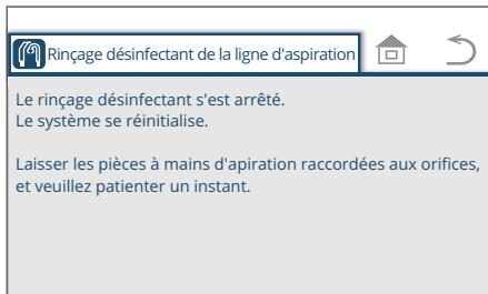
\* Si l'interrupteur est enfoncé pendant le lavage, l'écran illustré sur la figure de gauche apparaît.
