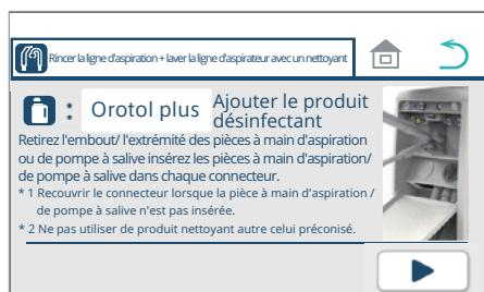
2. Démarrez le rinçage de la conduite d'aspiration + lavage de la conduite d'aspiration avec le nettoyant.
