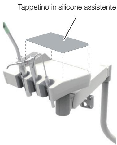
Passarli in autoclave a una temperatura di 134 °C per 3 minuti. Oppure, pulire la superficie con un panno morbido inumidito con disinfettante FD366 prodotto da Dürr.
