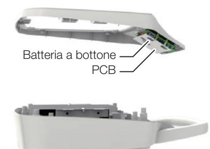
3. Staccare la batteria a bottone (CR1632) sul PCB.
