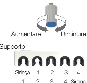
Tutte le manopole diminuiscono la portata quando vengono ruotate in senso orario e la aumentano quando vengono ruotate in senso antiorario.
