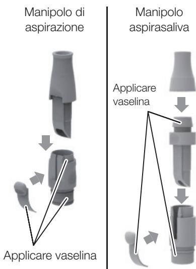
Dopo la sterilizzazione in autoclave, smontare i manipoli, applicare vaselina e riassemblare prima dell'uso.
