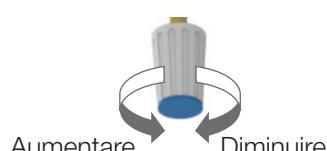
Tutte le manopole diminuiscono la portata quando vengono ruotate in senso orario e la aumentano quando vengono ruotate in senso antiorario.
