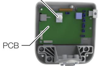
2. Staccare la batteria a bottone (CR1632) sul PCB.
