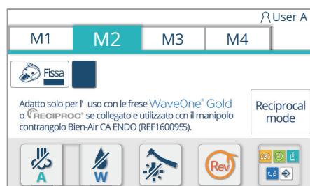
In modalità reciproca, il micromotore oscilla all'angolo, alla velocità di accelerazione e al valore di coppia preimpostati.
